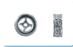
IN-106Z 外径φ7.6mm 厚み2.8mm 穴径φ0.8mm 珠φ5.0～ キュービックジルコニア9ヶ
