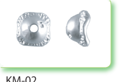
KM-02 外径φ7.0mm 厚み3.8mm 穴径φ1.1mm 珠φ6.0～8.0
